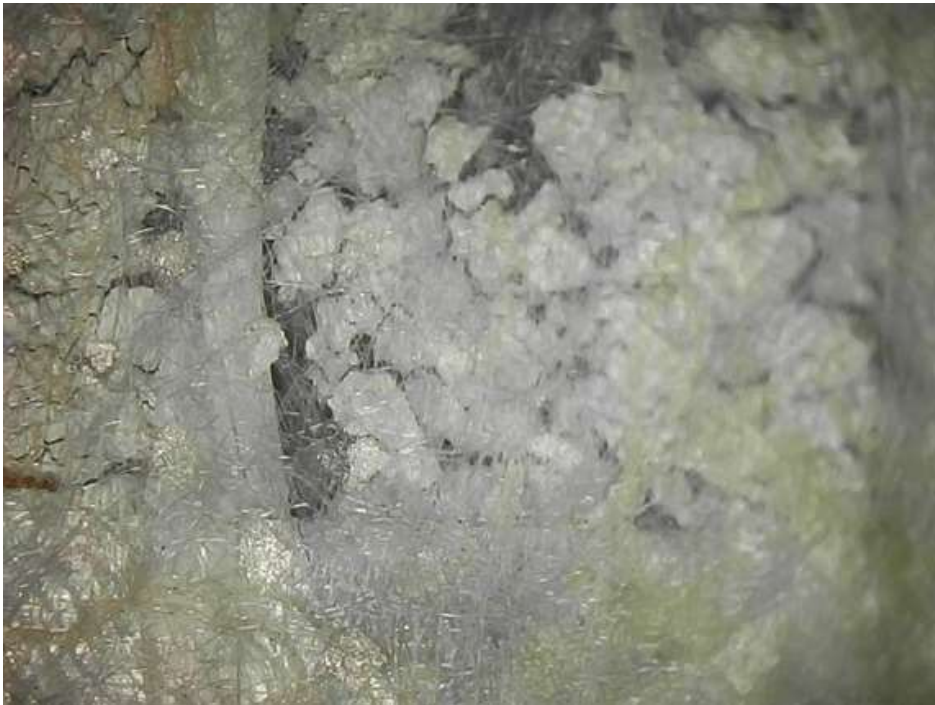
Mikroporöse Bahn nach 12 Wochen Freibewitterung
