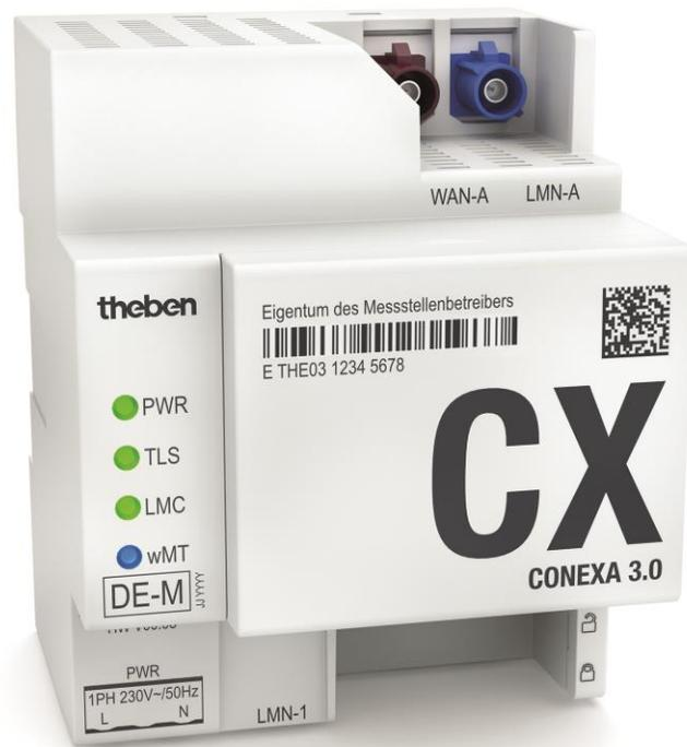
Smart Meter Gateway ermöglicht virtuelle Zählung an Untermesspunkten durch den Netz-/Messstellenbetreiber
