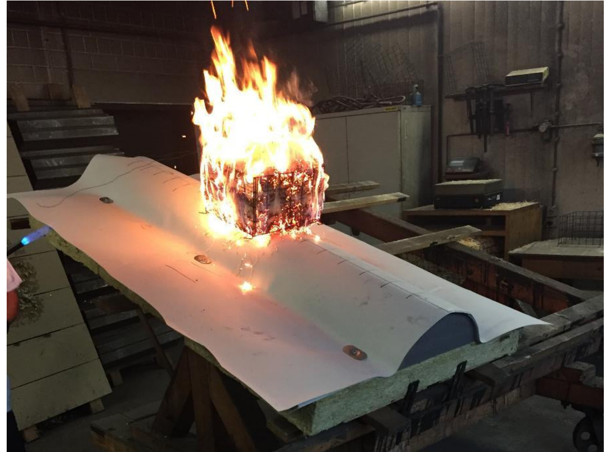
Prüfung DIN EN 1187 - Broof T1 20°C mit Brandkorb
