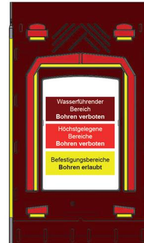
Die Wannen an den 4 verbleibenden Befestigungspunkten der GSE-Wanne mit einem 10mm-Bohraufsatz vorbohren.
